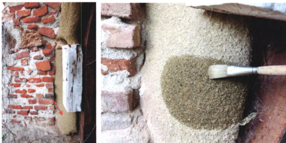
Test de consolidare prin impregnarea repetată a suprafeței litice.
