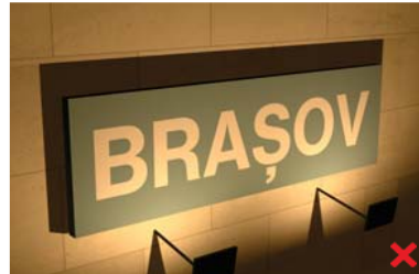
5. Panou- sursă exterioară lumină ascendentă
