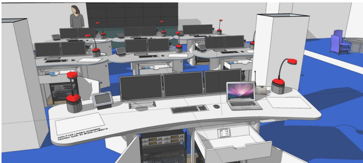
Figura 32 – Schema tipică de poziționare față de ecran în Camera de Comandă – vedere de la operator (simulare)
