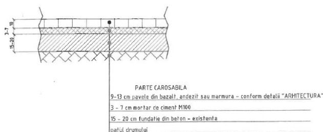
Fig. 3: Detaliu local al alcătuirii pavimentului, cu relevarea fundației de beton armat
