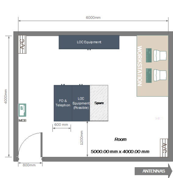
Figura 4: Aspect tipic pentru shelter localizator
